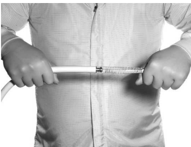
FIGURA 5. RETIRADA INCORRECTA DE LA PUNTA DESMONTABLE
