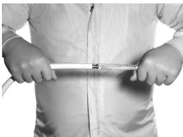
ABBILDUNG 5. UNSACHGEMÄSSE ENTFERNUNG DER ABNEHMBAREN SPITZE
