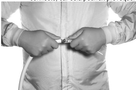
FIGURE 3. RACCORDEMENT DE L'EMBOUIT AMOVIBLE AU CÂBLE À FIBRES OPTIQUES
