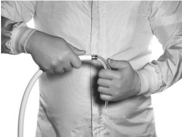
FIGURA 4. SCOLLEGARE LA PUNTA RIMOVIBILE CON UN MOVIMENTO DI PEELING
