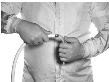
ABBILDUNG 4. ENTFERNEN DER ABNEHMBAREN SPITZE MIT EINER LÖSENDEN BEWEGUNG
