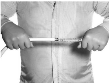
AFBEELDING 5. ONJUISTE VERWIJDERING VAN AFNEEMBARE TIP
